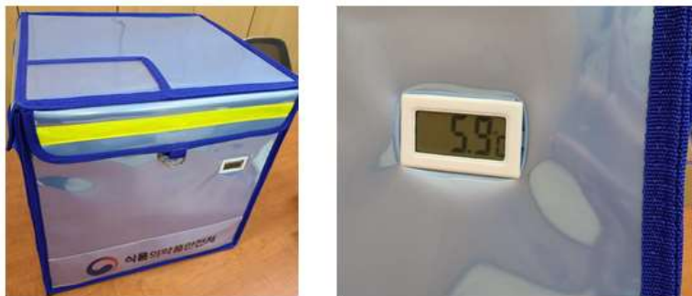
[그림 2. 수송용기에 설치된 온도계 예시]
